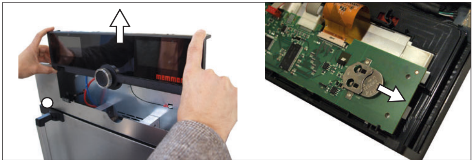
Fig. 25 Fjernelse af litumbatteri
