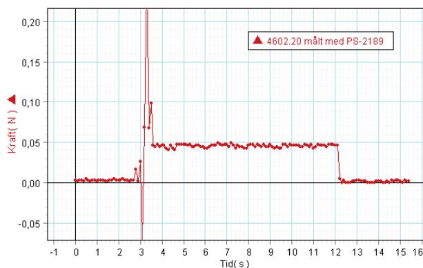
Bremsekraften, som påvirker magneten (rettet opad), modsvarer af en lige så stor og modsat rettet reaktionskraft (nedad) på faldrenden, så længe magneten falder med jævn hastighed. (Newtons III lov.)
